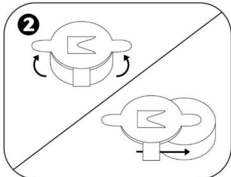
На задней панели экрана, поднимите лапки батареи и извлеките батарею.
