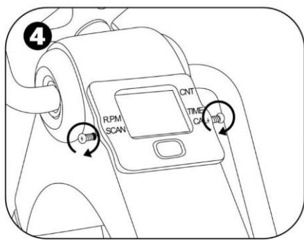
Вставьте дисплей в гнездо обратно и закрепите его с помощью винтов.
