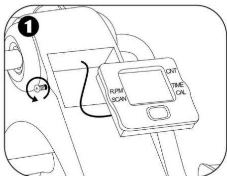
Ослабьте и снимите винты на каждой стороне боковой части экрана, затем аккуратно выньте дисплей из гнезда.
